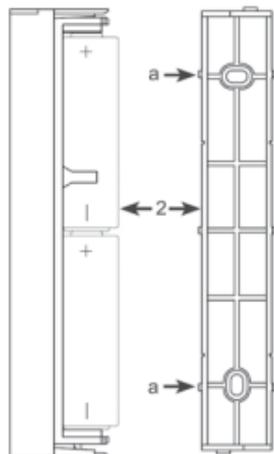
**i** Bei Verwendung des 14,5 mm hohen Distanzstücks müssen Sie dieses zunächst mit zwei Schrauben 2,2 x 16 mm befestigen und dann die Magneteinheit (1) mit zwei weiteren Schrauben darauf fixieren. Die flacheren Distanzstücke werden einfach zusammen mit dem Magneten durch 2 Schrauben 2,2 x 16 mm befestigt.
